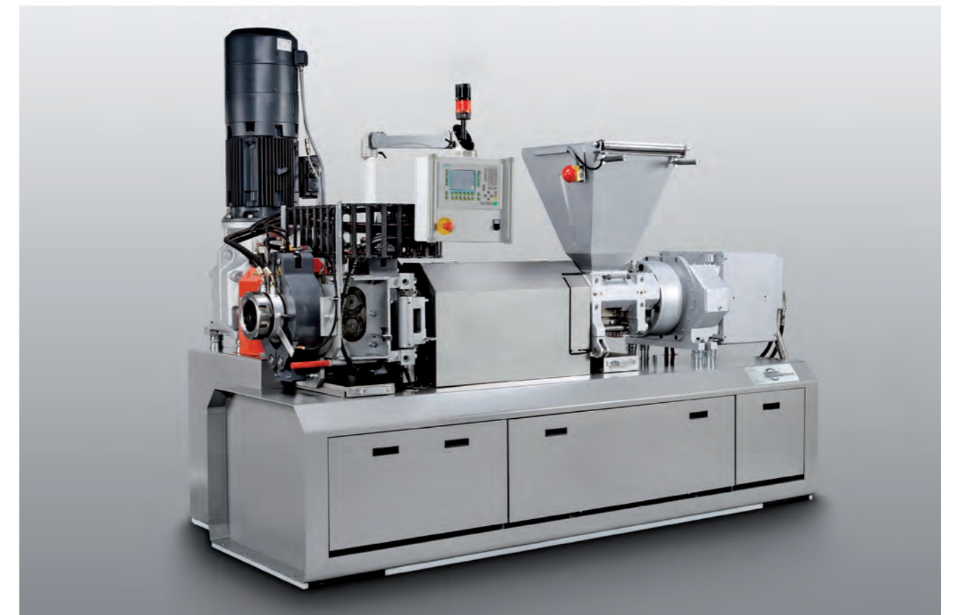
Zahnradpumpe für hohe Genauigkeitsanforderungen, mit einem 120 mm Kompaktextruder zur Herstellung von Profilen
