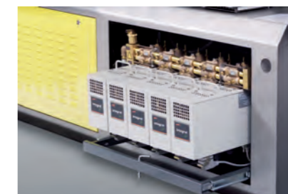
Temperiergeräte herausziehbar für Wartungszwecke
