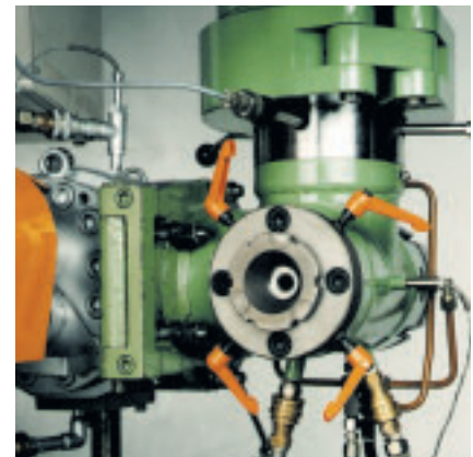
Querspritzkopf mit hydraulischer Pinolen-Ausdrückvorrichtung
