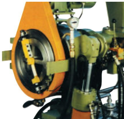
Strainer-Kopf mit Messervorsatz Strainer Head with knife attachment
