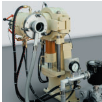
Querspritzkopf mit Vakuum-Anschluß und hydraulischer Klemmschelle
