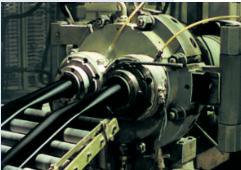
Doppelschlauch-Spritzkopf für Fahrschläuche (max. Ø 150 mm)
